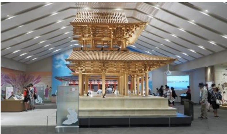
第一次大極殿の復原にあたり製作された1／5の構造模型
